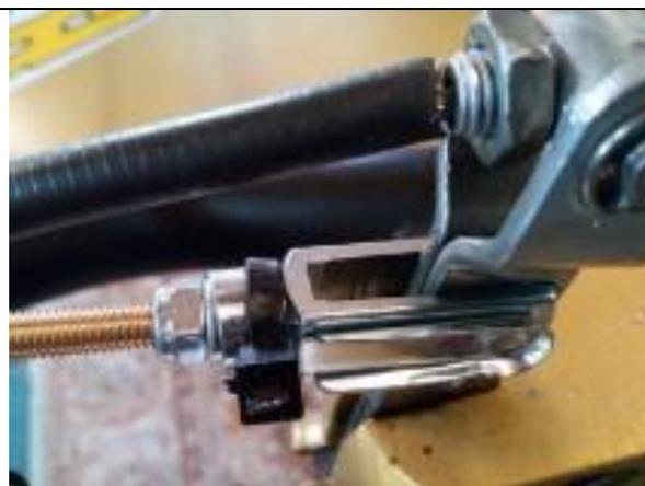
Les vis de maintien des plaquettes doivent être sécurisées à avec un câble de diamètre de 1mm minimum, dans le cas où c'est possible (voir photo).
