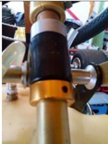
**Les supports de colonne de direction démontables.**
